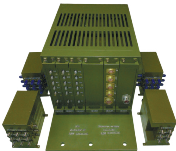
3-канальный преобразователь частоты диапазона 0,1 - 18,0 ГГц, серии Радиотехника-1.
